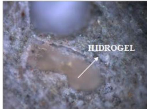
Foto 2: Microscopía óptica del hidrogel generado en la muestra de hormigón
