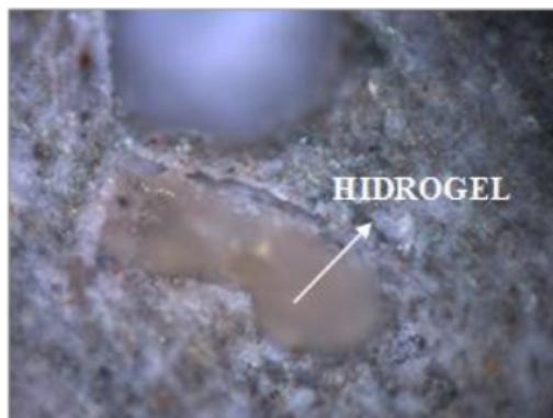
Image 2 : Microscope optique à hydrogel généré dans l'échantillon de béton
