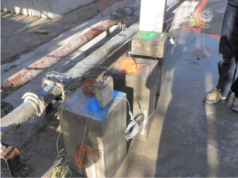
Foto 2: Probetas terminadas con sus terminales de medida
